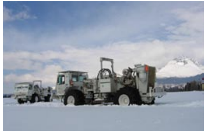
Wibratory – pojazdy wzbudzające fale sejsmiczne
